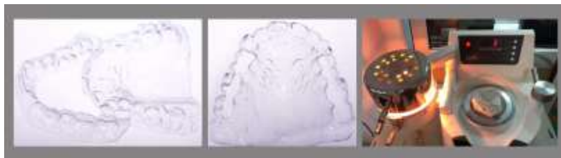
Рис. 2. Капа з ізофолану, отримана після вакуумного пресування на гіпсових моделях за допомогою апарата MiniStar.
